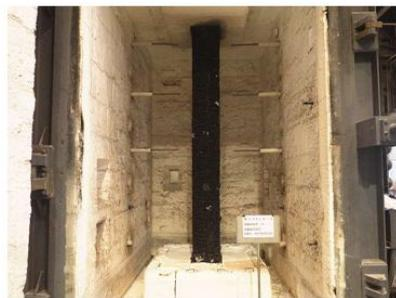
2時間耐火構造柱 性能評価試験
