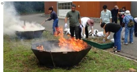
製炭器内を高温に保つよう燃えすぎに注意しながら、全ての剪定枝葉を投入しました。炭化が終了したら、水をかけて消火します。水蒸気が一気にたちこめ、辺りは真っ白になりますが、ひるまずに水をかけ続け、製炭器内をかき混ぜていると黒い炭が見えてきます。完全消火を見届け、作業終了です。
