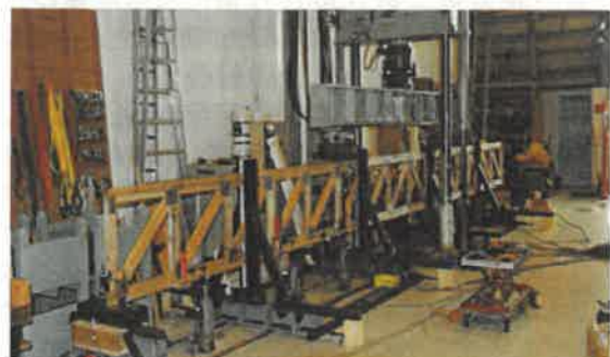
写真2 県産スギのツーバイフォー製材トラスの強度試験の様子
