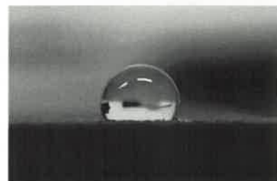
画像2. 木材表面へのアモルファスカーボン コーティングによる撥水化
