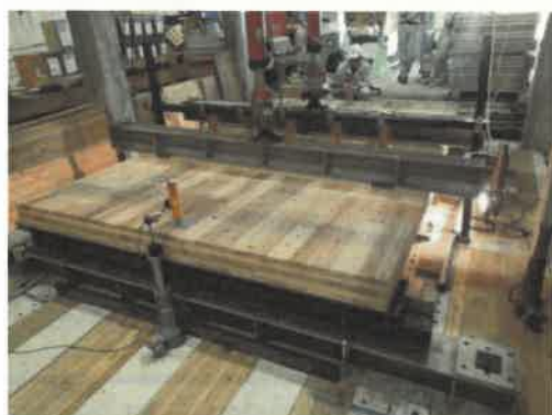
2.4m幅のCLTの曲げ試験
