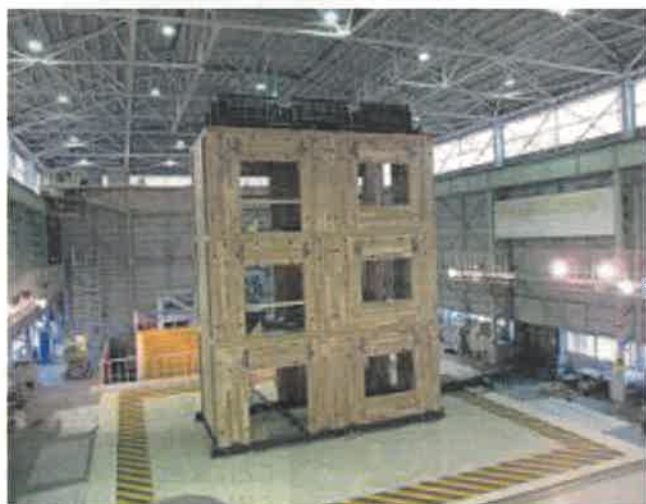
3階建てCLT工法の加震実験(つくば)
