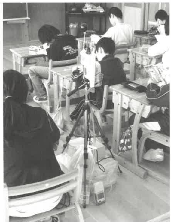
写真2. 教室中央に配置した測定機器類（温熱快適性測定器（PMV計）、温湿度計、二酸化炭素濃度測定器、空気捕集ポンプ） 能代市立浅内小学校）
