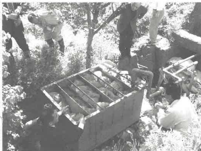
水質浄化濾材試験の様子 (二ツ井町内)
