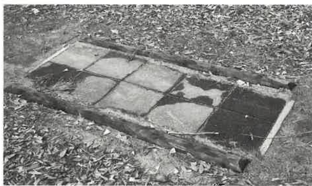
写真1 スギ樹皮舗装材料の耐久性試験
