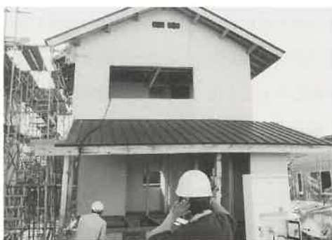
写真1: 大加力時の在来型A棟の変形状況。建物全体が浮き上がって回転するが、内外壁と屋根面の立体コアが何とか抵抗。
