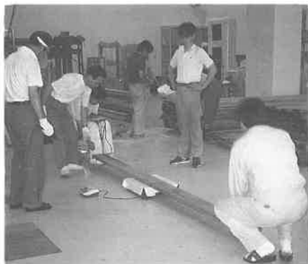
振動法による部材のヤング率測定
