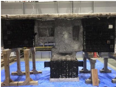
図3 鉄骨接合部被覆
