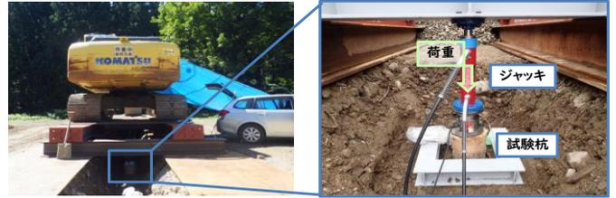
写真2 木杭の鉛直載荷試験の様子
