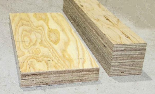
写真2 試作された超厚合板 左: 厚さ60mm、右: 同140mm
