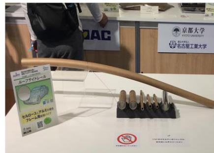
コンセプトカーでは巻き芯となるアルミ管をそのまま残したマルチマテリアルとして実装することで、CNFの高い力学性能を生かしたまま接合方法の選択幅を拡げています。この部材はコンセプトカーではキャビンの天井フレームとして用いられており、残念ながら完成車では内外装材料の下に隠れて見えなくなっていました。ちなみに、木高研で開発した円筒形LVLも同様の成型技術を応用したものであり、昭和丸筒(株)とはそれ以来20年ぶりの協働となりました。
