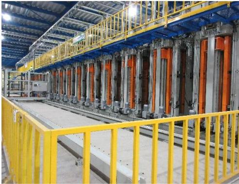
こうした視点はスギ集成管柱の工程でも生かされています。(秋田の)スギはどうしても死節が抜けてしまうので、ラミナとして集成管柱の外層を補修する必要があります。ここではその作業をロボットがおこないます。画像をバーコードにしてそれをロボットが読み込んで認識し、指示を受けたアームが節を抜いて埋めていく。その節を埋める作業をおこなうロボットが11台。節を埋める作業に要する時間は節一個につき2、3秒とか。その早さは目にも止まりません。
