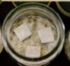
耐朽性試験(木材小試験片)
