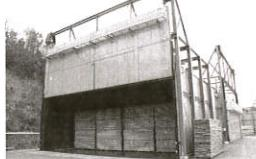
写真4 中温200m<sup>3</sup>タイプの乾燥機
