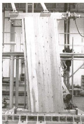
写真1 厚板壁のせん断試験
