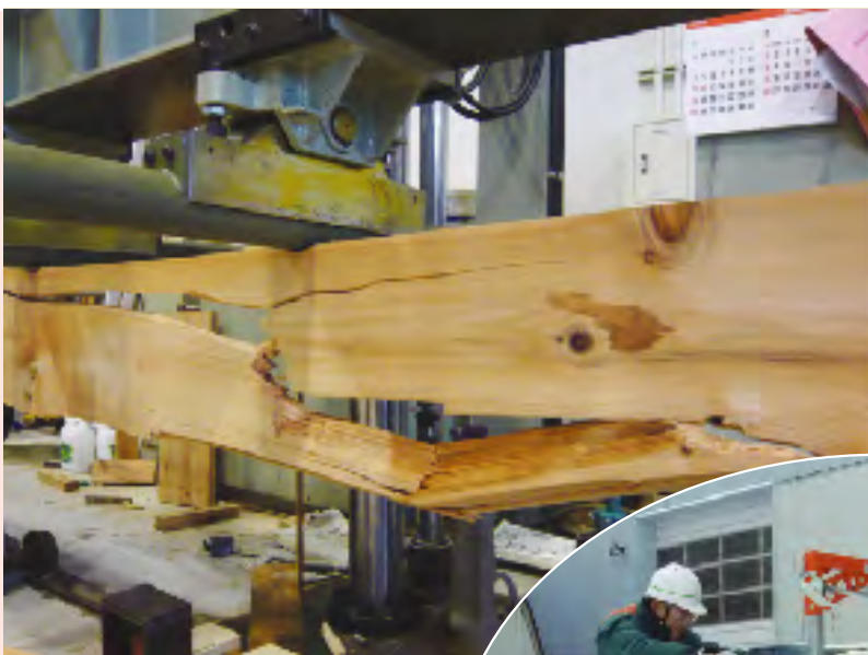
秋田スギ厚板の破壊（強度）試験
