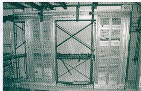
面材耐力壁・木ダボラーメン構法試験の様子
