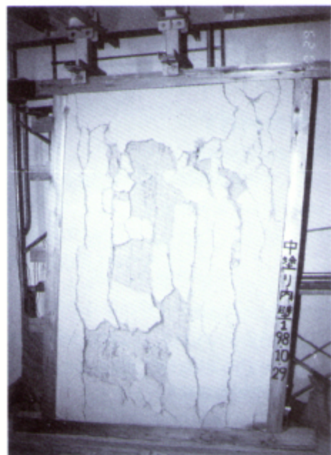
写真2. 1998年に実施した秋田型土壁の水平加力試験風景
