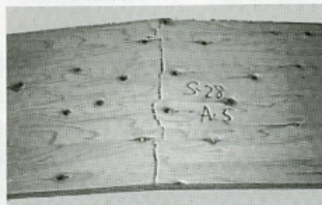
スギネダノン曲げ破壊状況
