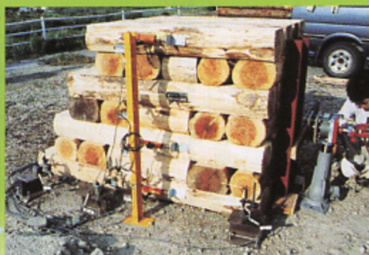
治山ダムの模型を使った安定性の確認試験(鹿角森林組合)
