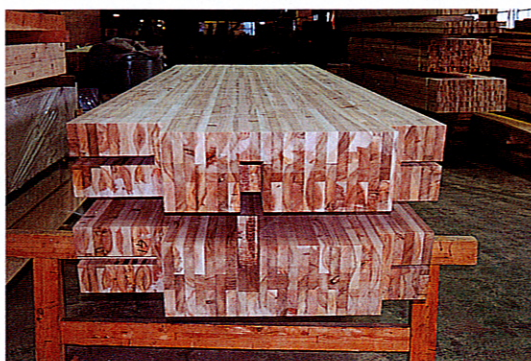
鋼板を組み合わせる前のスギ集成材の主桁
