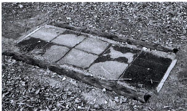
写真1 スギ樹皮舗装材料の耐久性試験
