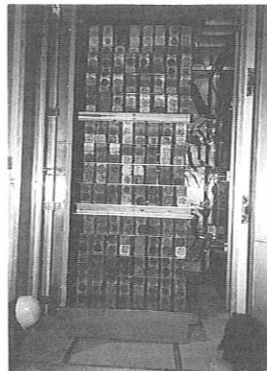
写真1 高周波・熱気併用乾燥機内に積み込んだ状態
