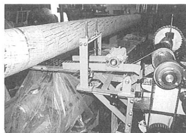
写真2 幾分自動化が進んだスパイラルワインダー
