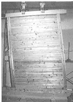
写真7 大きな水平変形にも柱脚の浮上りだけで耐えている板壁
