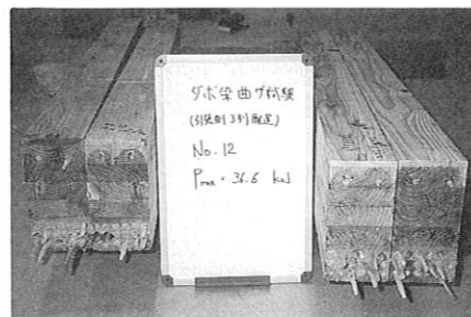
ダボ接合による曲げ強度の試験片
