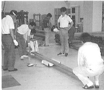
振動法による部材のヤング率測定
