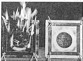
(写真8. セラミックウッドの燃焼実験)
